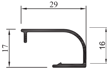
AM - 230 Contravidrio curvo 29 mm Peso: 0,213 kg/m Largo: 6030 mm Paquete x 12 tiras
